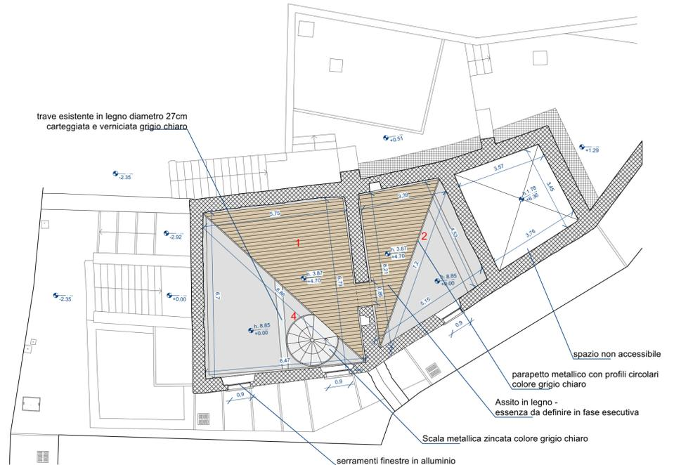
PIANTA PIANO PRIMO - CROMATISMI STATO DI FATTO
